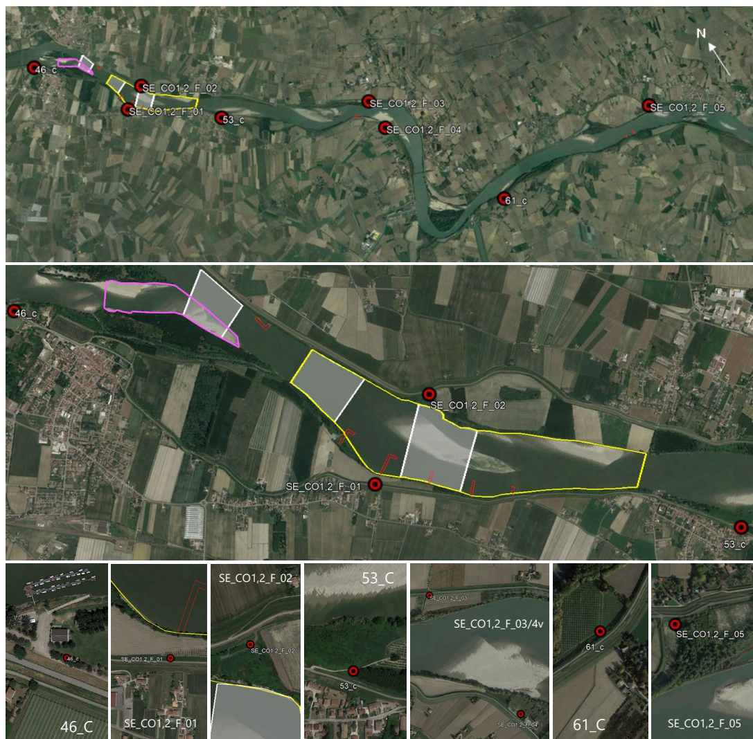
Figura 7 – Localizzazione delle stazioni di monitoraggio della componente SE: l'area delimitata di rosa = misure spettroradiometriche (SE_xx_B_01); le aree bianche = segmenti fluviali per il calcolo degli indicatori HMS e HQA del metodo CARAVAGGIO (da monte a valle, SE_xx_C_01, 02 e 03); in giallo = il segmento per il calcolo dell'indicatore IQMm (SE_xx_C_01) (in rosso evidenziati i sedimi dei pennelli).
